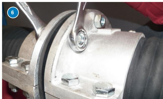
6 Положите прокладку по возможности концентрично между фланцами. Плотно завинтите фланцы друг с другом. Герметичность обеспечивается только давлением поверхности среза шланга на прокладку.
